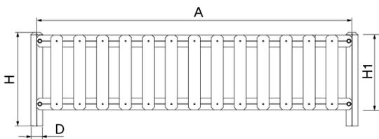
**Estructura, Madera laminada:** Madera de pino escandinavo laminada y con tratamiento autoclave (clase IV). Acabado con dos capas de Lasur. -En el caso de estar sometida a condiciones meteorológicas variables, la madera laminada puede presentar pequeñas grietas que no reducen su durabilidad. La resina y los nudos son su parte natural.
